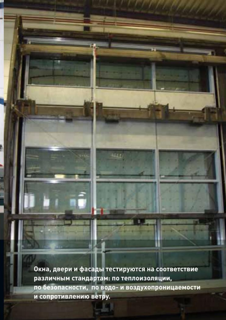
Окна, двери и фасады тестируются на соответствие различным стандартам: по теплоизоляции, по безопасности, по водо- и воздухопроницаемости и сопротивлению ветру.
