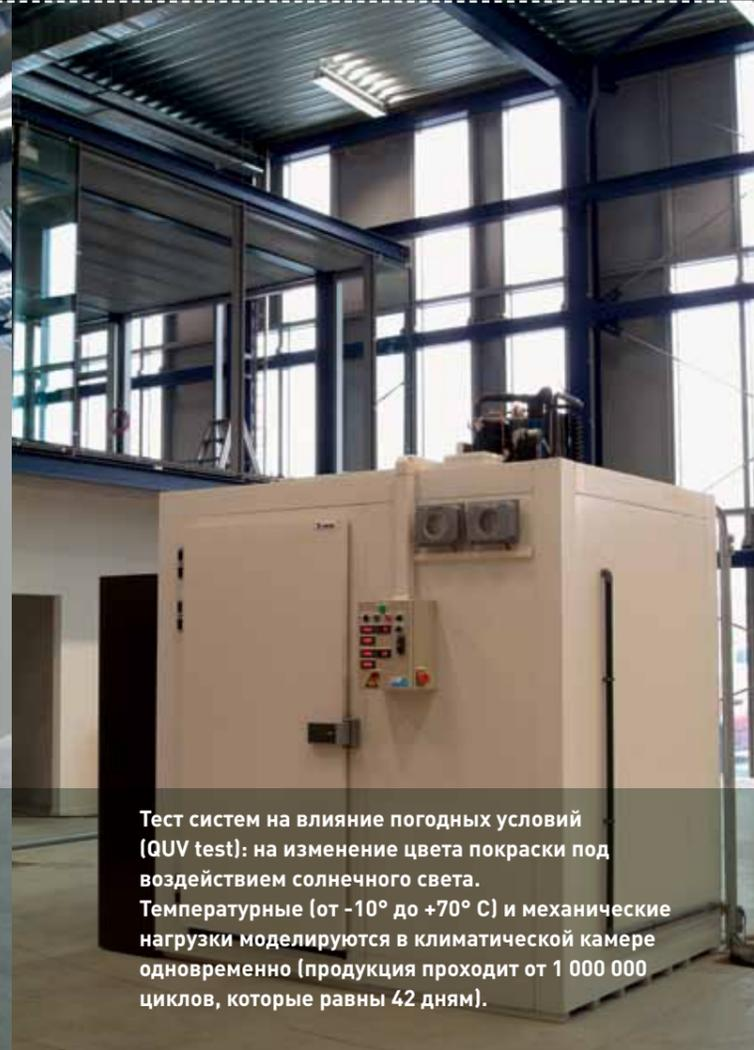
Тест систем на влияние погодных условий (QUV test): на изменение цвета покраски под воздействием солнечного света. Температурные (от  $-10^{\circ}\text{C}$  до  $+70^{\circ}\text{C}$ ) и механические нагрузки моделируются в климатической камере одновременно (продукция проходит от 1 000 000 циклов, которые равны 42 дням).
