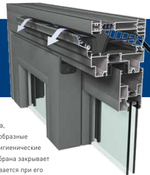
Ventalis - это вентиляционная система, которая устанавливается на окна, двери и раздвижные системы для обеспечения притока воздуха. Разнообразные конфигурации удовлетворяют различные эстетические вкусы, а также гигиенические нормы по естественной вентиляции помещений. Запатентованная мембрана закрывает поступление воздуха, когда сила ветра увеличивается до 25 Па и открывается при его уменьшении, тем самым препятствуя сквознякам.
