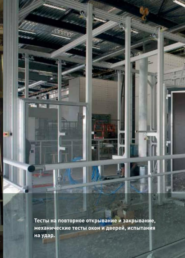
Тесты на повторное открывание и закрывание, механические тесты окон и дверей, испытания на удар.
